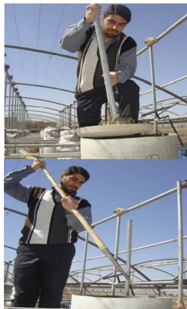
(تصویر ۱) - نمایی از نحوه کوبیدن (الف) و خراش دادن (ب) سطح خاک
