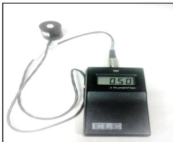
شکل ۲: نمای ظاهری و پاسخ طیفی تابش سنج فعال فتوسنتزی مورد استفاده در پژوهش (شرکت ELE).
