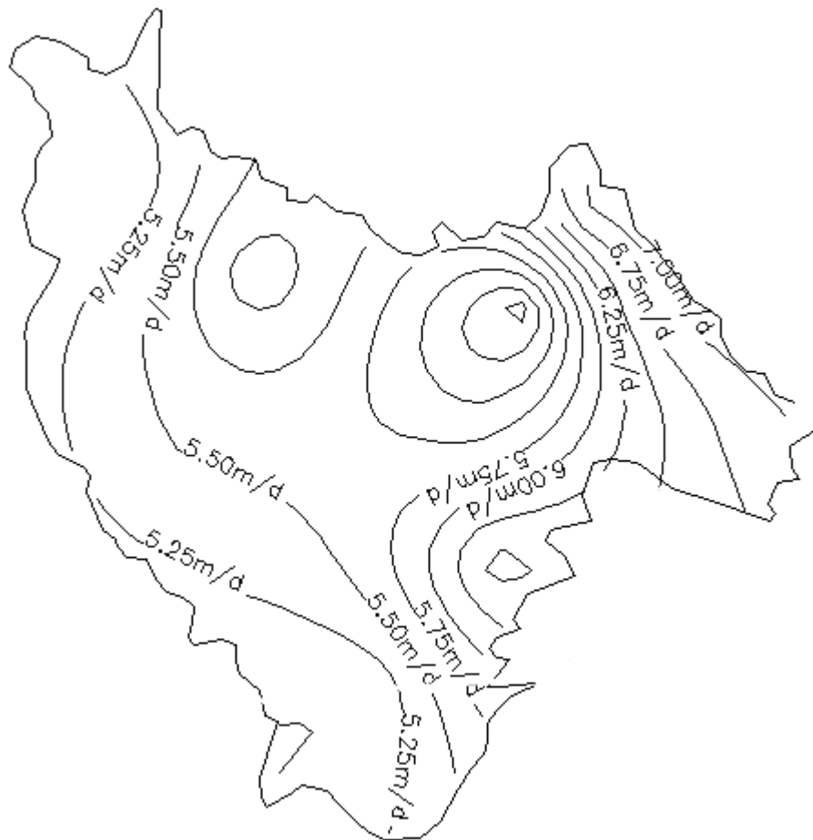
شکل ۸- نقشه هدایت هیدرولیکی واسنجی شده (متر در روز) Figure8- Calibrated hydraulic conductivity map (m/day)
