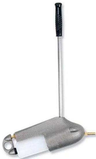
شکل ۳- نمونه بردار دستی DH-48 برای اندازه‌گیری بار معلق Figure 3- Manual sampling DH-48 for measuring the suspended load
