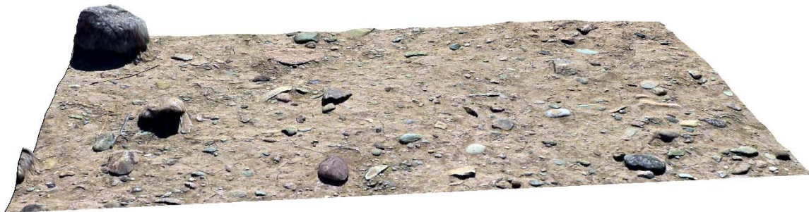
شکل ۸- مدل سه بعدی سطح زمین حاصل تحلیل فوتوگرامتری در نرم افزار PhotoScan Figure 8- Three-dimensional terrain model by photogrammetric analysis in PhotoScan
