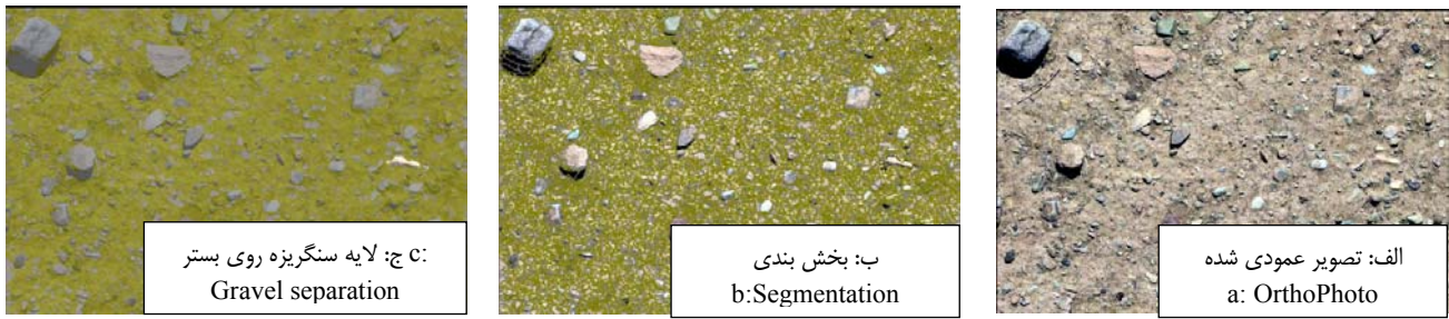
شکل ۱۰- مراحل طبقه‌بندی شیء‌گرا در نرم افزار eCognition (تصویر ب بخش‌بندی و تصویر ج طبقه‌بندی نهایی) Figure 10- Object based classification process in eCognition software, (a) orthogonal image, (b) segmentation, and (c) Final classification
