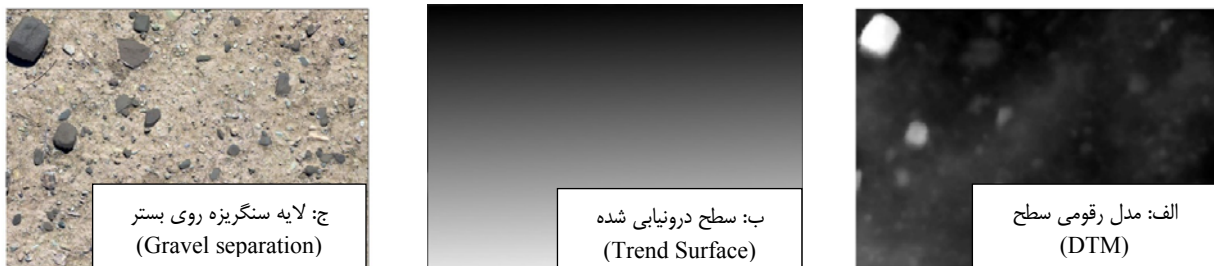
شکل ۹- مراحل تعیین سنگریزه به روش درونیابی چندجمله‌ای Figure 9- Gravel determining process by polynomial interpolation method
