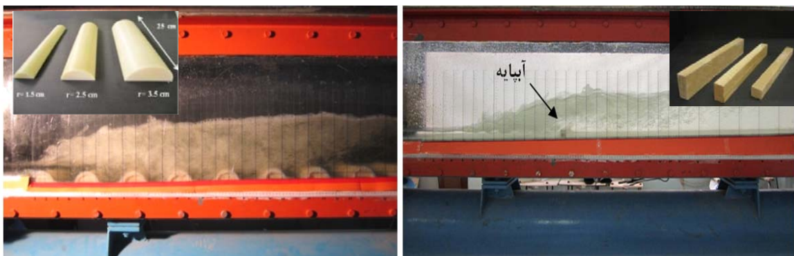
شکل ۲- آبپایه و زبری‌های نیم استوانه‌ای شکل با ارتفاع ۱/۵، ۲/۵ و ۳/۵ سانتی‌متر و نمونه ای از تشکیل پرش هیدرولیکی
