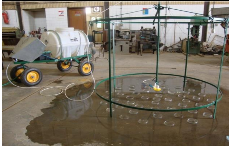
شکل ۲- نمایی از دستگاه باران ساز در مرحله آزمایش یکنواختی بارش
