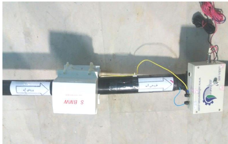
شکل ۱- دستگاه ایجاد میدان مغناطیس برای تیمارهای آب مغناطیسی Figure 1- Magnetic field creation device for magnetic water treatments
