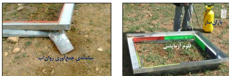
شکل 2- تصاویری از شبیه‌سازی باران و اندازه‌گیری روان‌آب با استفاده از فلوم‌های کوچک در منطقه مرتعی کدیر
