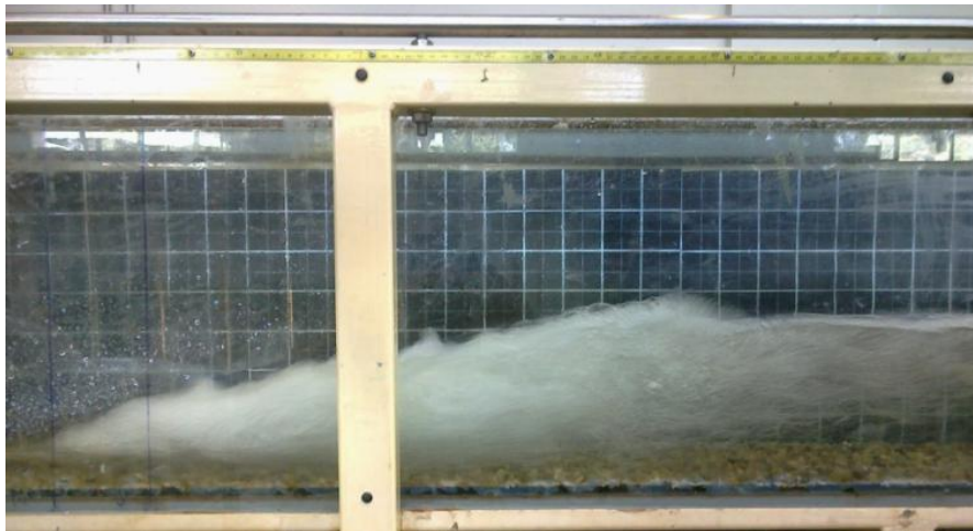
شکل ۸- نمایی از پرش هیدرولیکی در بستر زبر ۳/۵ میلی‌متر Figure 8- Hydraulic jump on rough bed 3.5 mm
