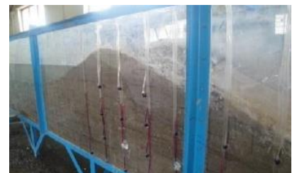
شکل ۱- وضعیت قرارگیری پیژومترها Figure 1- Experimental Flume and Pizometer
