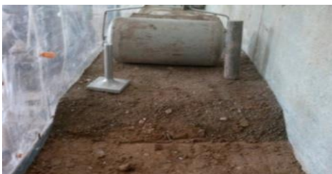
شکل ۷- نمایی از خاکریز سد. الف) وسایل تراکم بدنه سد ب) تقسیم‌بندی بدنه سد
