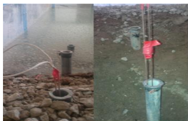
شکل ۳- استفاده از زوج میله‌ها در چاهک‌ها Figure 3- Resistance related Height of instrument calibration
