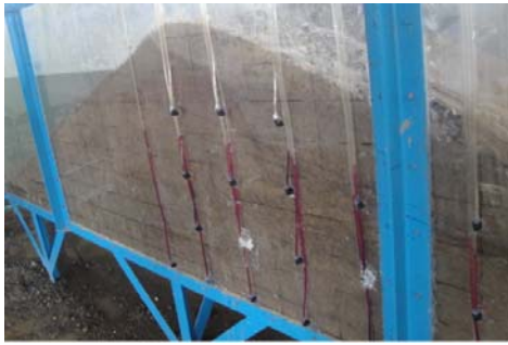
شکل ۳- پیزومترها نصب شده روی بدنه فلوم برای اندازه گیری فشار آب منفذی
