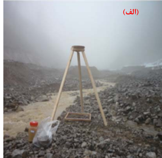
شکل ۲- مراحل اندازه‌گیری بار بستر در محل نمونه‌برداری از طریق استقرار سامانه عکس‌برداری (الف) و شبکه مربعی برداشت نمونه (ب)
