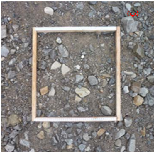
شکل ۲- مراحل اندازه‌گیری بار بستر در محل نمونه‌برداری از طریق استقرار سامانه عکس‌برداری (الف) و شبکه مربعی برداشت نمونه (ب)
