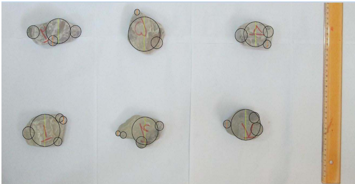
شکل ۳- تصویری از مقاطع ذرات رسوب تهیه شده از مقطع بالادست معدن واز علیا در آذر ۱۳۹۱ به منظور تعیین شعاع دوایر تیزترین گوشه بزرگ‌ترین دایره محاط در ذرات رسوبی
