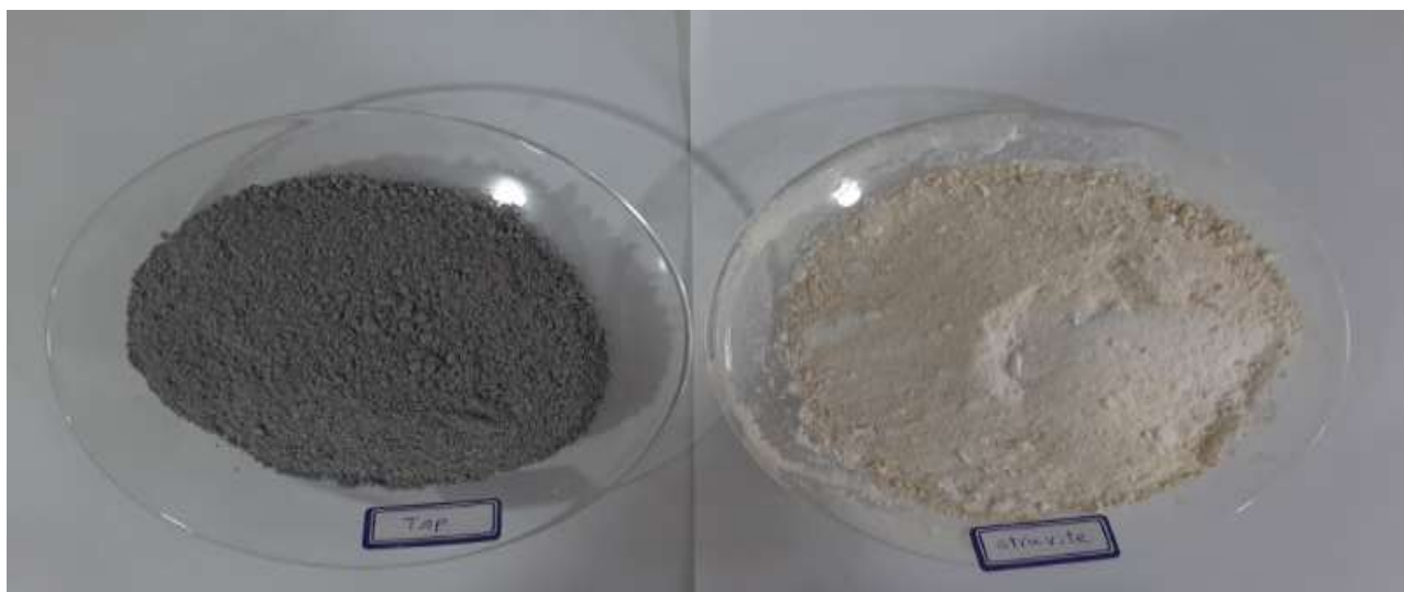
شکل ۱- استروویت (فسفات آمونیوم منیزیم) بازیابی شده از خاکستر لجن فاضلاب (راست) و کود فسفر تجاری (سوپرفسفات تریپل) (چپ) Figure 1- Recovered struvite from sewage sludge ash (magnesium ammonium phosphate) (right) and commercial phosphorus fertilizer (triple superphosphate) (left)
