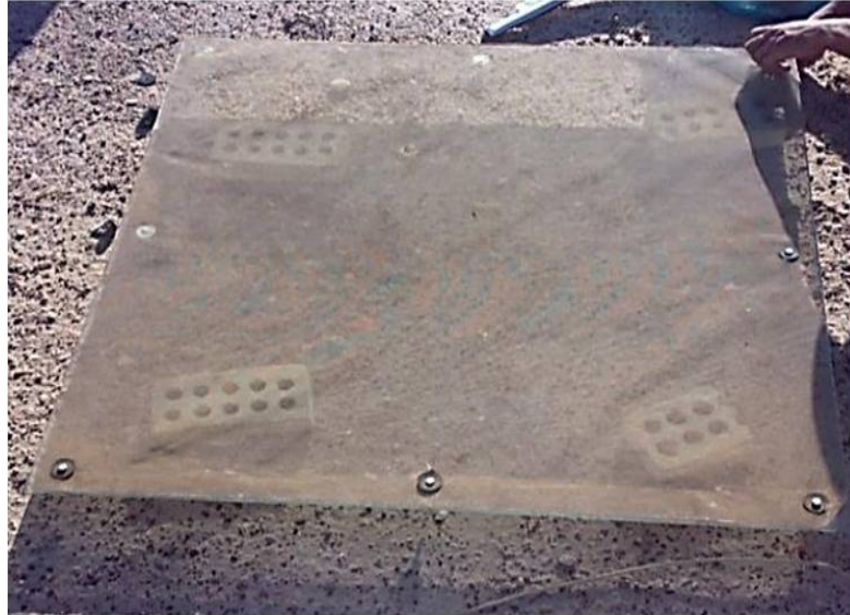
شکل ۲- سطح شیشه‌ای مورد استفاده در نمونه‌برداری از ذرات گرد و غبار (۷) Figure 2- The glass surface used in the sampling of dust particles
