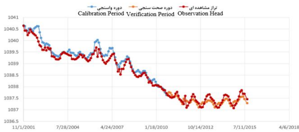
شکل ۹- سطح آب مشاهده ای و محاسباتی در پیزومتر جاده لنگر در دوره واسنجی و صحت سنجی Figure 9- Observed and Calculated groundwater level in Aliabad piezometer during calibration and verification periods
