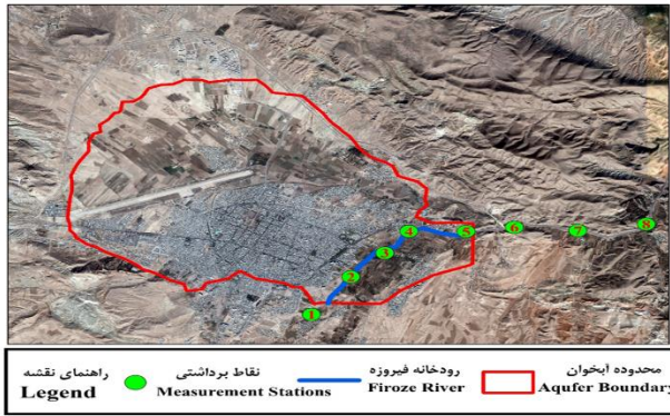
شکل ۴- موقعیت نقاط برداشت شده و رودخانه در بازدید دوم Figure 4- Location of river flow measurement stations (the second visit)
