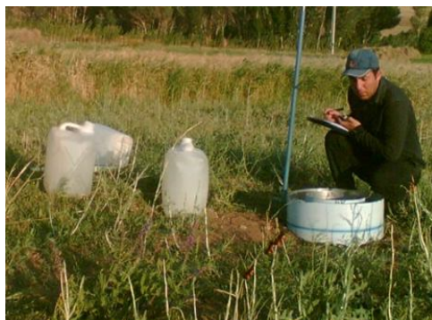
شکل 4- اندازه‌گیری نفوذپذیری خاک با استفاده از استوانه مضاعف در کشت آبی Figure 4- Measurement of soil infiltration rate using double rings in an irrigated land.
