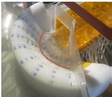
شکل 4- تشکیل پرش هیدرولیکی در پای سرریز
