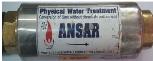
شکل ۱- دستگاه مغناطیسی مورد استفاده برای انجام آزمایش Figure 1- Magnetic device used to conduct experiment
