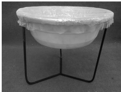
شکل ۲- تله مورد استفاده جهت جمع‌آوری گرد و غبار Figure 2- Sampler used for dust collection
