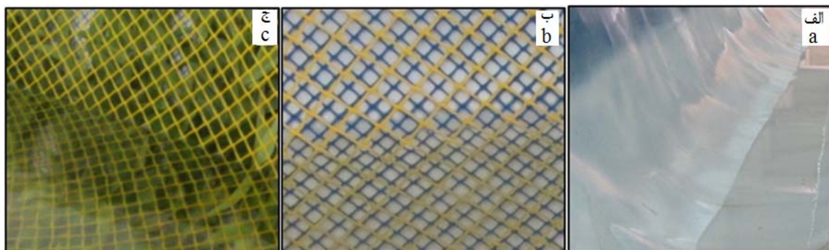
شکل ۲- زبری‌های مختلف (الف) کف کانال با ضریب زبری ۰/۰۲، (ب) پهن کردن دو توری روی هم با ضریب زبری ۰/۰۴ و (ج) پوشش گیاهی بین توری‌ها با ضریب زبری ۰/۰۶
