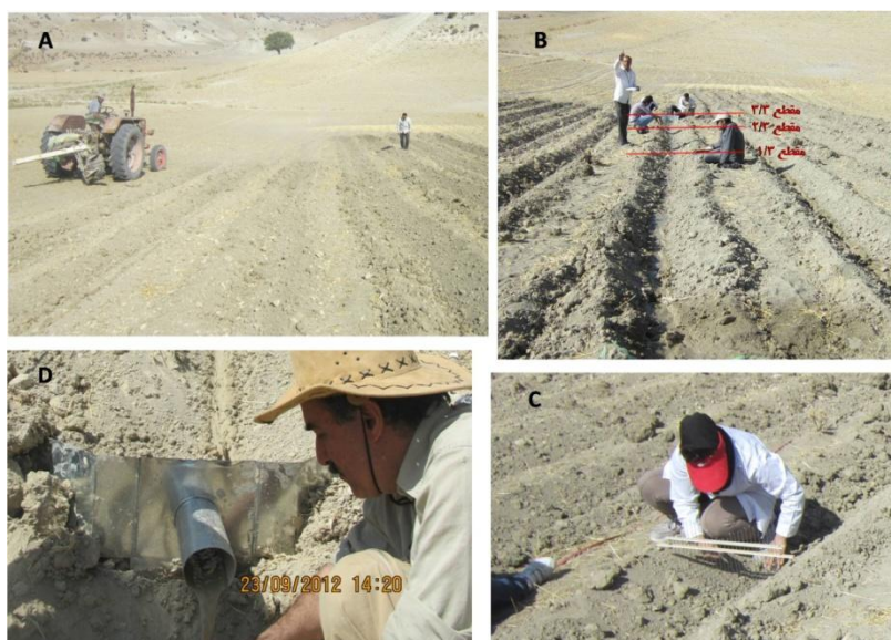
شکل ۲- ایجاد شخم به روش سنتی و تولید شیار (A)، اندازه‌گیری در مقاطع مختلف (B)، اندازه‌گیری سطح مقطع به وسیله شیارمتر (C) و جمع‌آوری روان‌آب و رسوب در انتهای شیار (D)
