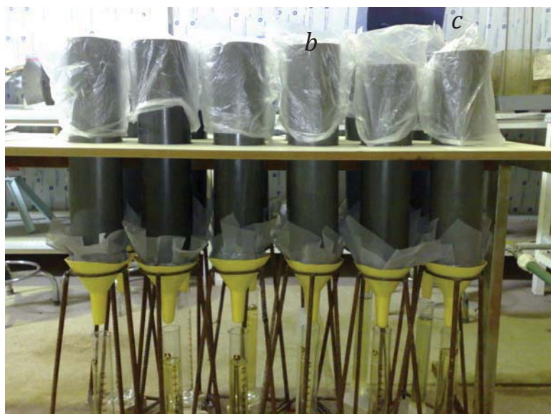
شکل ۱ - پوشاندن ستون‌ها توسط پلاستیک و جمع آوری زه‌آب خروجی
