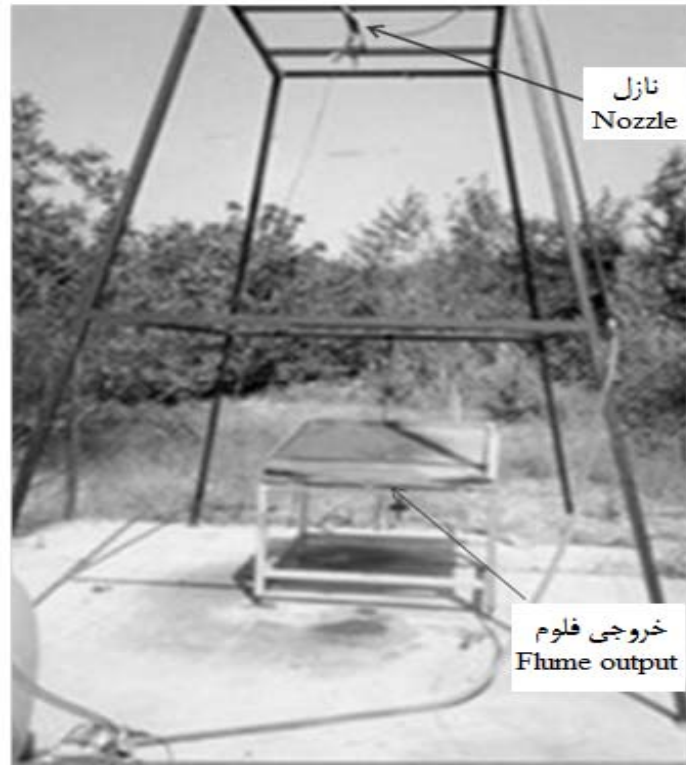
شکل ۲- نمایی از سینی باران ساز مورد استفاده در این مطالعه Figure 2- Illustration of the tray and rainfall simulator used in this study
