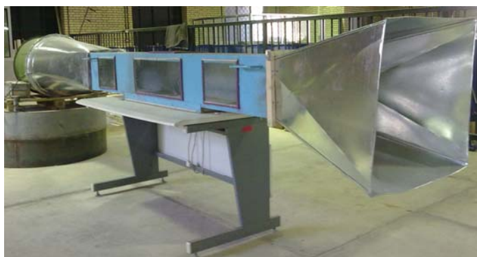
شکل ۱- تونل بادی ساخته شده به ترتیب از راست به چپ: تبدیل، تونل باد و پنجره های جانبی آن، پخش کننده و فن
