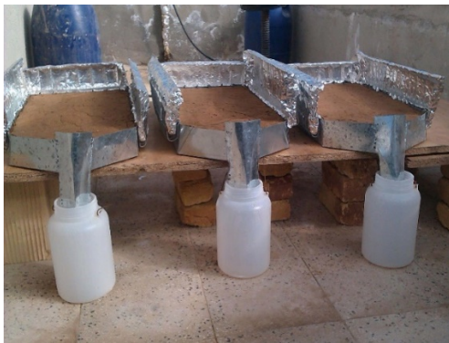
شکل ۱- نمای از دستگاه شبیه‌ساز باران مورد استفاده در پژوهش (الف) و فلوم‌های آزمایشی و ظرف‌های جمع‌آوری رواناب و رسوب (ب) Figure 1- Experimental flumes and containers for collecting runoff and soil loss
