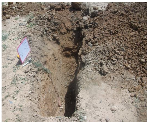
شکل ۲- حفر نیم‌رخ‌های خاک با استفاده از بیل مکانیکی و اندازه‌گیری عمق نیم‌رخ‌های خاک Figure 2- Drilling of soil profiles using mechanical excavator and measurement of soil profiles depth
