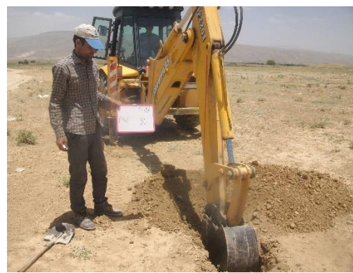
شکل ۲- حفر نیم‌رخ‌های خاک با استفاده از بیل مکانیکی و اندازه‌گیری عمق نیم‌رخ‌های خاک Figure 2- Drilling of soil profiles using mechanical excavator and measurement of soil profiles depth
