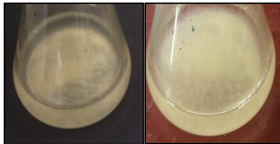
شکل ۲- رسوب کلسیت تشکیل شده توسط باکتری اسپورسارسینا پاستئوری پس از ۴۸ ساعت Figure 2- Calcite precipitation formed by Sporosarcina pasteurii after 48 hours
