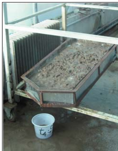
شکل ۲- جمع‌آوری رواناب و رسوب در فلوم تحت باران شبیه‌سازی شده
