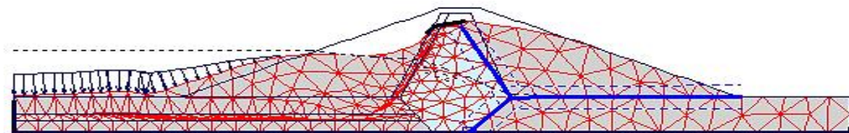
شکل ۵- تغییر شکلهای ایجاد شده در بدنه سد پس از وقوع زلزله Figure 5- Developed deformations on the dam body after earthquake
