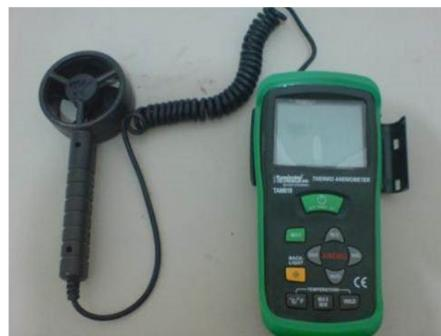
شکل 3- نمایی از بادسنج دستی دستگاه تونل باد
