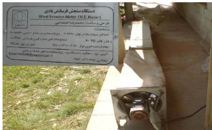
شکل ۲- نمایی از تولید باد آزمایش
