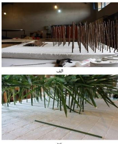
شکل ۳- مدل‌های پوشش گیاهی الف) انعطاف‌پذیر ب) سخت Figure 3- Models of vegetation a) Flexible b) Rigid
