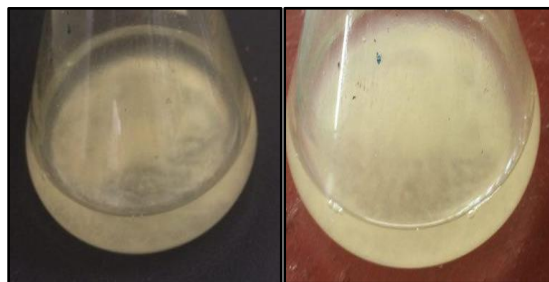
شکل ۲- رسوب کلسیت تشکیل شده توسط باکتری اسپورسارسینا پاستوری پس از ۴۸ ساعت
