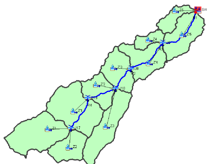
شکل ۷- شمایی از مدل حوضه ساخته شده در HEC-HMS از حوضه آبخیز زشک Figure 3- Scheme of basin model made in HEC-HMS from Zashk watershed
