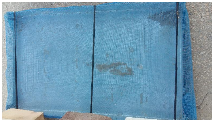
شکل ۲- نمونه رسوب گیر مخزنی برای جمع آوری ذرات معلق
